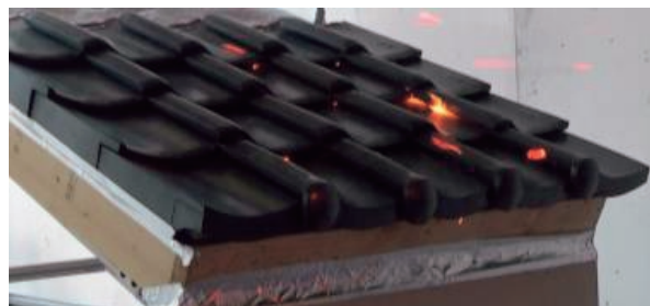
日本瓦の下から炎が見える様子(風速9m/s)
